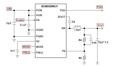
Fig 3: BD9B300MUV-E2EVK-101 Evaluation Board I/O
