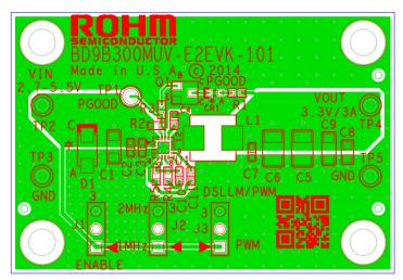
Fig 34: BD9B300MUV-E2EVK-101 Board PCB layout
